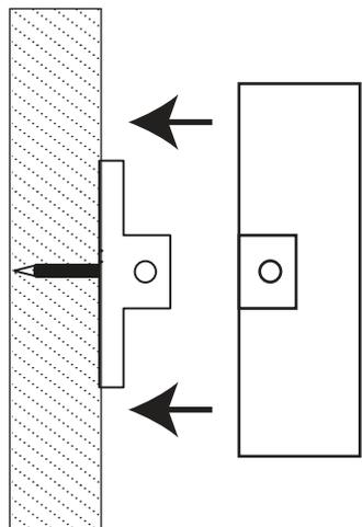
**ВНИМАНИЕ! Обязательно проверьте надежность крепления светильника к монтажной скобе!!!**
